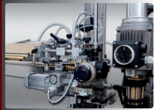
Estaciones de etiquetado gestionadas desde pantalla táctil. Accionados con motor paso a paso y driver de control de exactitud con encoder basado en la tecnología de las etiquetadoras rotativas.
