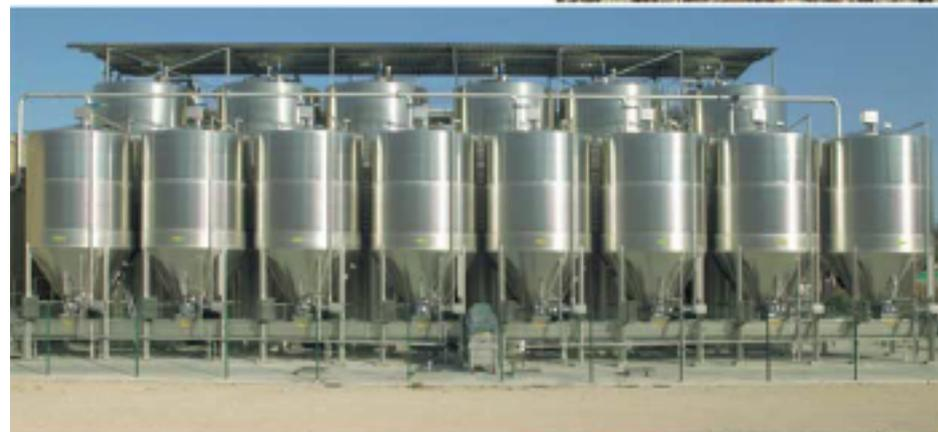
CUVE DE VINIFICATION. Avec cuvon de délestage, avec vidage
